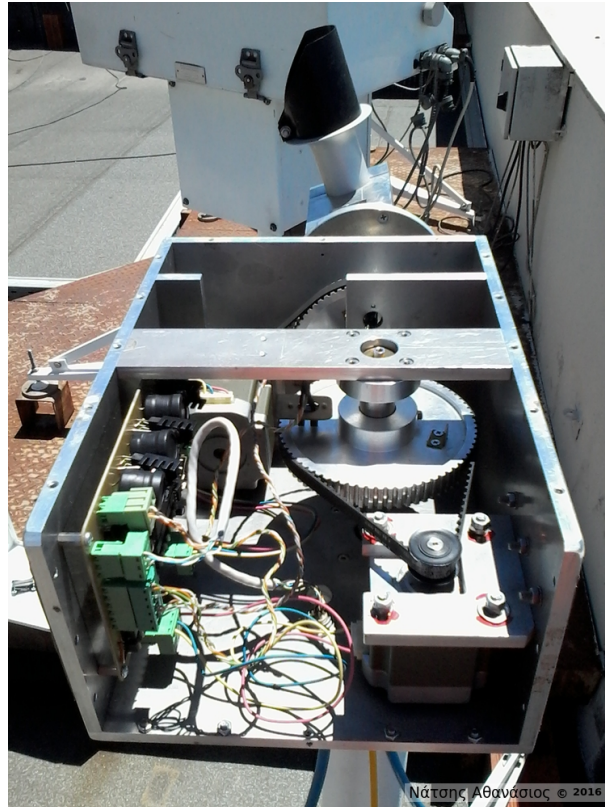
Εικόνα 1.1: Εσωτερικό του πρώτου μοντέλου tracker. Φαίνονται τα κύρια γρανάζια των αξόνων, ο κινητήρας του αξιμούθιου άξονα και το ηλεκτρονικό σύστημα ελέγχου, καθώς και το CHP 1.
